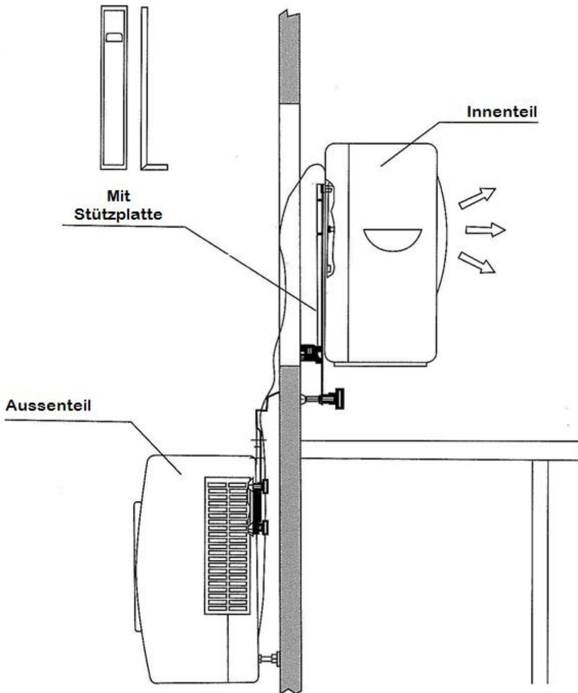
Befestigen Sie innen die Stützplatten an den Bügeln mithilfe der beiden Knöpfe mit Innengewinde. Jetzt können Sie das Außenteil über die Stützplatten schieben.
