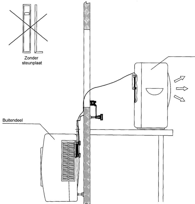
Bevestig de grote beugels aan het buitendeel van de airco, door per beugel twee schroefdoppen kruiselings vast te zetten. (Twee schroefdoppen zitten al op hun plaats, twee worden los bijgeleverd).
