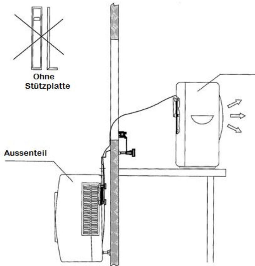
Befestigen Sie die großen Bügel am Außenteil der Klimaanlage, indem Sie per Bügel zwei Schraubverschlüsse kreuzweise fixieren. (Zwei Schraubverschlüsse sind schon an ihrer Position, zwei weitere werden lose mitgeliefert.)
