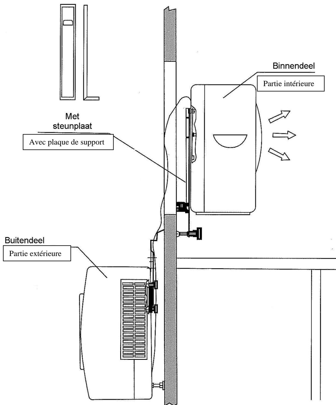
Fixez à l'intérieur les plaques de support aux consoles à l'aide des deux boutons avec fil intérieur. Vous pouvez à présent faire coulisser la partie intérieure sur les plaques de support.
