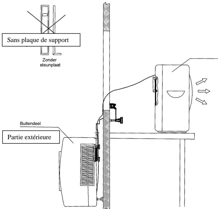
Fixez les grandes consoles à la partie extérieure du climatiseur en serrant diagonalement deux bouchons à vis par console. (Deux bouchons à vis sont déjà à leur place, deux autres accompagnent séparément le produit.)
