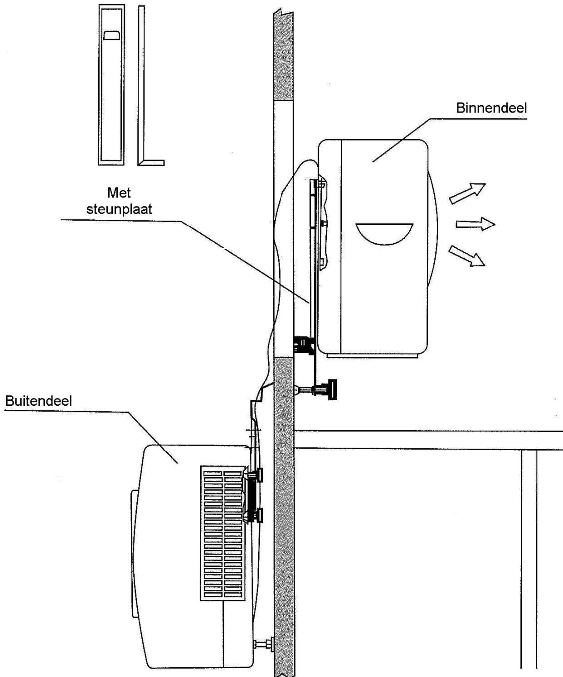
Bevestig binnen de steunplaten op de beugels met behulp van de beide knoppen met binnendraad. Nu kunt u het binnendeel over de steunplaten schuiven.
