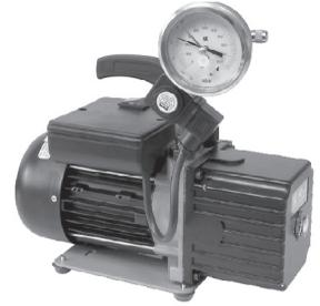
Das Elektroventil schließt automatisch die Verbindung zum System, sobald der Schalter der Pumpe ausgeschaltet wird, daher kann das Vakuummeter effizient die Stabilität des erreichten Vakuums messen; es zeigt jedoch lediglich die Veränderung an, das bedeutet, den Verlust des Vakuums des Systems. Ein herkömmliches Vakuummeter mit Uhr kann nie das erreichte Endvakuum messen, da dieses unter seinem Messbereich liegt.
