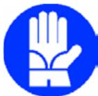
Guanti: Durante le pulizie e le operazioni di manutenzione, è necessario l'uso di guanti appropriati. In caso di ricarica del gas refrigerante, è obbligatorio l'utilizzo di guanti appropriati per evitare il rischio di congelamento.
