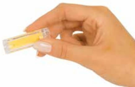
Der schnelle und kostengünstige Test auf Säure. Eine Rotverfärbung deutet auf anorganische Säuren im Kreislauf hin.
