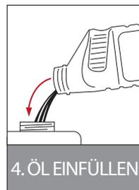
Vakuumpumpen benötigen sauberes, wasserfreies Öl, um das notwendige tiefe Vakuum zu erreichen. Verschmutztes Öl wird zu einer Mischung aus zersetzenden Säuren und Wasser, welches die Fähigkeit ein Vakuum zu ziehen beeinträchtigt. In der Pumpe belassen greift diese Mischung Oberflächen an, zersetzt diese und verkürzt die Lebensdauer. Wir raten daher, Vakuumpumpenöl regelmäßig zu ersetzen.
