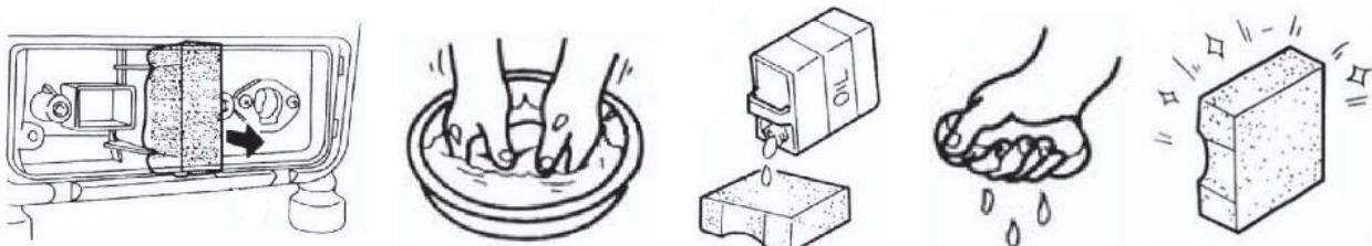
Reinigen Sie den Luftfilter nach jeweils 150 Betriebsstunden oder drei Monaten (je nachdem, was zuerst eintritt). Schrauben Sie dazu die Platte an der Steckdosenseite (zwei große Kreuzkopfschrauben) ab. Nehmen Sie den Luftfilter (Schaumblock) heraus und waschen Sie ihn in sauberem Benzin. Tropfen Sie etwas Motorenöl (SEA20) darauf und drücken (nicht: wringen!) Sie den Filter gut aus.
