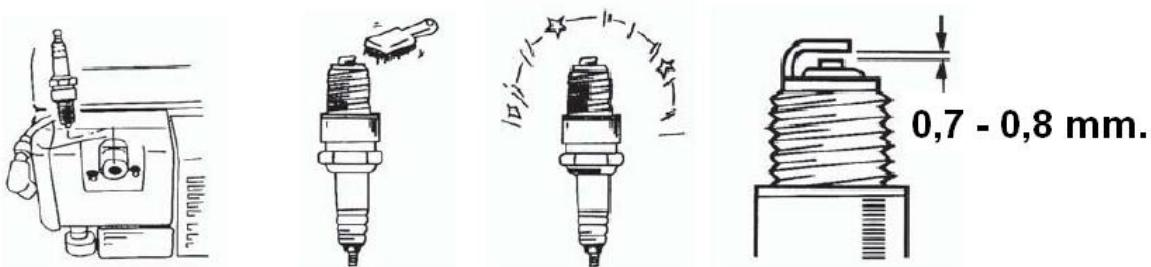
Contrôlez la bougie après chaque période de 50 heures de fonctionnement. Enlevez les dépôts de calamine, contrôlez si la bougie n'est pas décolorée et rectifiez au besoin l'ouverture (0,7 à 0,8 mm), ou remplacez la bougie par un même type.
