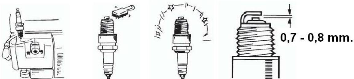
Controleer na elke 50 werkuren de bougie. Verwijder koolstof-aanslag, controleer of de bougie niet verkleurd is en stel zonodig de opening bij (0,7 tot 0,8 mm.), of vervang de bougie door eenzelfde type.
