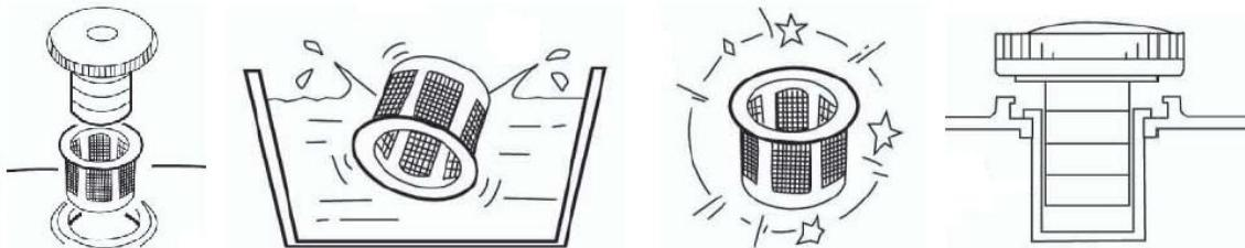
Reinigen Sie den Kraftstofffilter, der sich in der Einfüllöffnung unter dem Tankdeckel befindet, nach jeweils 150 Betriebsstunden oder drei Monaten (je nachdem, was zuerst eintritt). Nehmen Sie den Filter aus der Öffnung, reinigen Sie ihn in sauberem Benzin, trocknen Sie ihn und setzen Sie ihn wieder ein. Ein beschädigter oder verschlissener Kraftstofffilter muss ausgetauscht werden. Verwenden Sie das Aggregat nicht ohne Kraftstofffilter!
