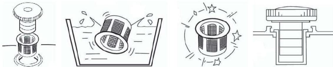
Nettoyez le filtre à carburant qui se trouve dans l'orifice de remplissage, sous le bouchon de réservoir, après chaque période de 150 heures de fonctionnement/3 mois (selon la première occurrence). Retirez le filtre de l'orifice, nettoyez-le dans un peu de benzine, séchez-le et remettez-le en place. Un filtre à air carburant endommagé ou usé doit être remplacé. N'utilisez jamais le groupe électrogène sans filtre à carburant !
