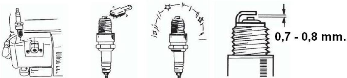
Prüfen Sie die Zündkerze nach jeweils 50 Betriebsstunden. Entfernen Sie Kohlenstoffablagerungen, kontrollieren Sie, ob die Zündkerze nicht verfärbt ist, und korrigieren Sie erforderlichenfalls den Abstand (0,7 bis 0,8 mm), oder ersetzen Sie die Zündkerze durch eine neue desselben Typs.
