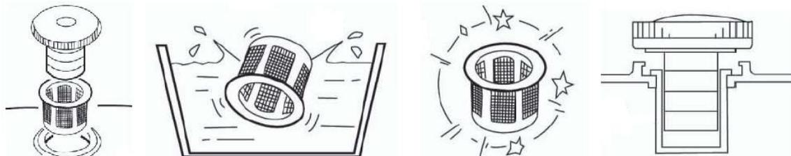
Reinig na elke 150 werkuren / 3 maanden (wat het eerst voorvalt) het brandstoffILTER dat zich in de vulopening, onder de tankdop bevindt. Neem het filter uit de opening, reinig het in wat schone benzine, droog het af en plaats het terug. Een beschadigd of versleten brandstoffILTER dient vervangen te worden. Gebruik het aggregaat nooit zonder brandstoffILTER!
