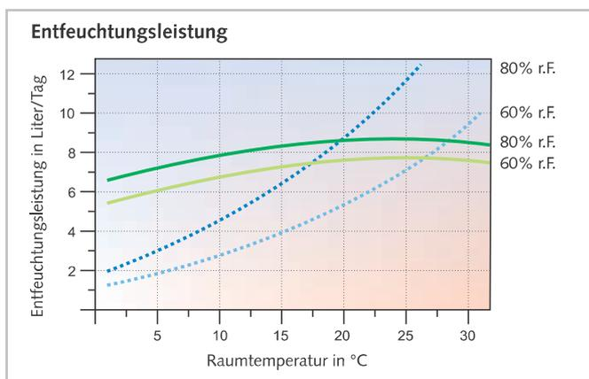
— REMKO ASF 100 mit Adsorptions-Rotor
