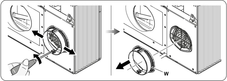
Bei Verwendung von Bohrungen mit  $\varnothing$  202 mm ist wie folgt vorzugehen:
