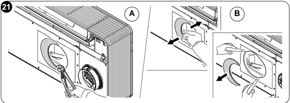
Die hintere Abdeckung ist auch für den rechteckigen Ansaugkanal vorgesehen. Sollte man diesen Installationstyp wählen, die rechteckige Vorstanzung aufbrechen und ein Ansauggitter von für den Ansaugkanal geeigneten Abmessungen verwenden.
