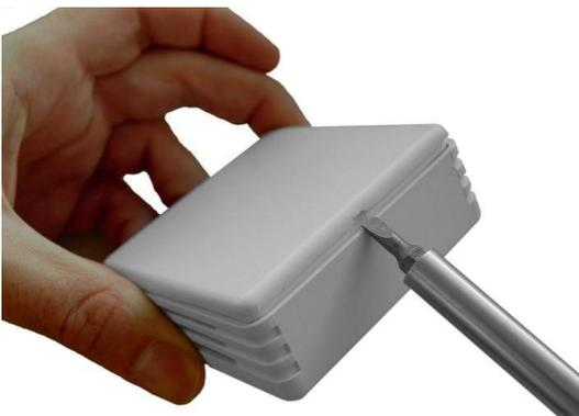
1. Abdeckung des Funkfeuchtesenders mit einem kleinen Schraubendreher vorsichtig anheben und abnehmen (Abb. 3.4.1).
