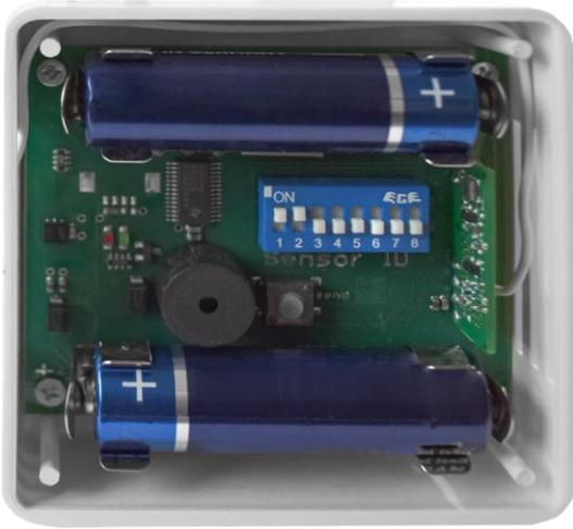
Abb. 3.4.2: Batterien einsetzen
